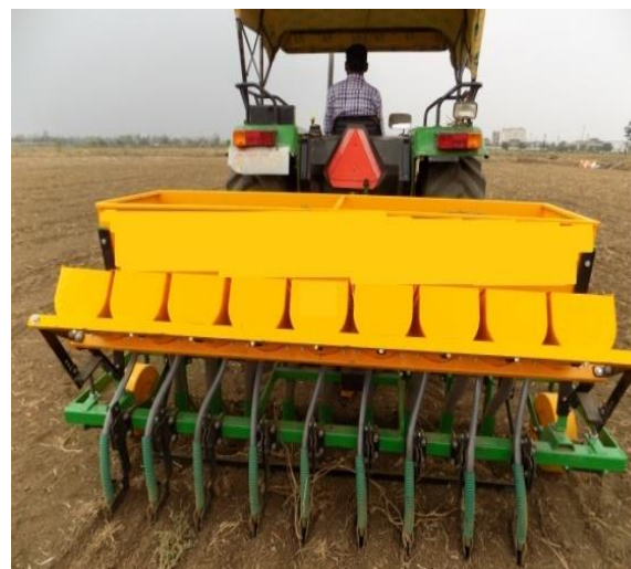
Fig. 2: FYM applicator cum planter in actual use
